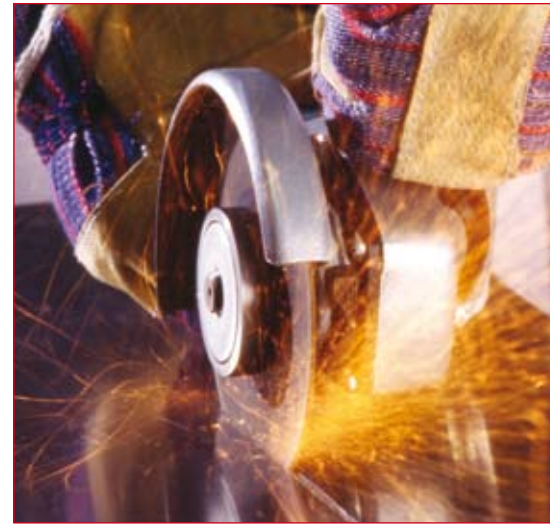
Es darf nur Material getrennt werden, das nicht unter Druck steht und dadurch die Scheibe einklemmen könnte
