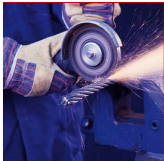
Beim Trennen ist die Richtung des Funkenflugs zu beachten, damit keine unbeabsichtigten Schäden in der Umgebung auftreten
