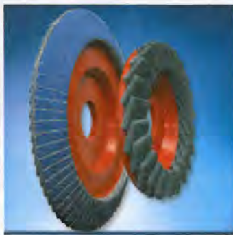
Das neue Schleif- und Poliersystem GPS Dual besteht aus einer Fächerschleifscheibe mit einem Durchmesser von 125 mm. In diese wird eine zweite Fächerschleifscheibe mit einem Durchmesser von 90 mm mit einer feineren Körnung oder eine Vliesfächerscheibe eingesetzt.
