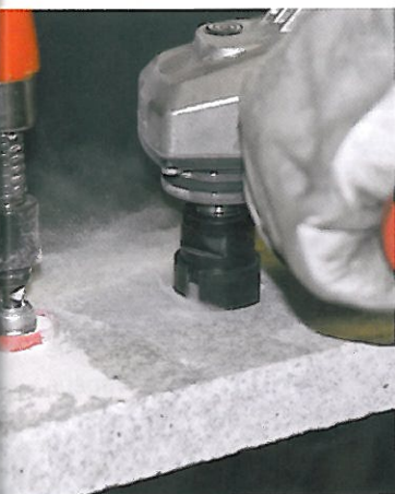
Beim Einsatz von »CeraDrill« ist kein Wasserkühlsystem erforderlich.
